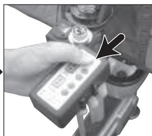
③コントロールボックスのスタート/ストップボタンを押してロボットを作動します。
