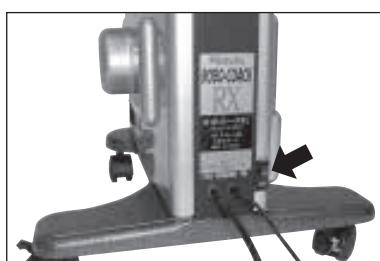
○電源プラグをコンセントに差し込み、本体の電源スイッチをONにします。
