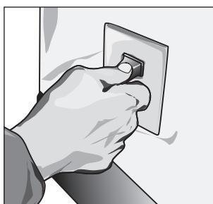
①電源スイッチを切り、電源プラグをコンセントから抜きます。
