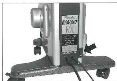
○電源プラグをコンセントに差し込み、本体の電源スイッチをONにします。
